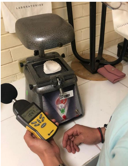
Fotografía 23: Obtención de decibelímetros del vacum sin activar el aire (ruido mínimo).
