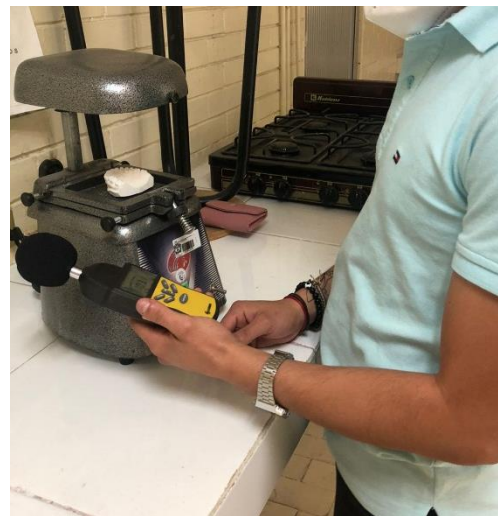
Fotografía 24: Obtención de decibelímetros del vacum con aire activado (ruido máximo).
