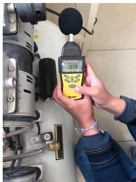
Fotografía 17(izquierda) y 18 (derecha) comparación de la intensidad de ruido del compresor.
